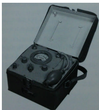
わが国初の携帯形可燃性ガス測定器 FM-1型
