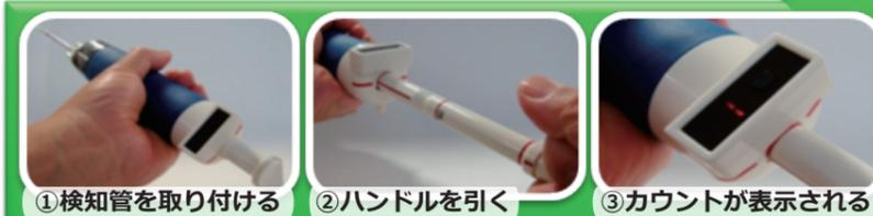
①検知管を取り付ける ②ハンドルを引く ③カウントが表示される
