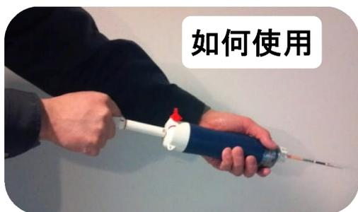
将气体检测管连接到气体采集器
