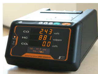
図2 光明理化学工業社製 自動車排気ガステスター4成分(CO/HC/CO2/O2)測定器
