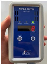
ハンディサイズのPM2.5計です。アクティブサンプリングであるため、応答性が良好です。小型であるため、測定者が持ち運びながら測定することも可能です。結果は内臓ロガーに保存されるため、後日時間とデータの解析が可能です。無音・無振動であるため、電車の中や工場内で測定しても、気になりません。
