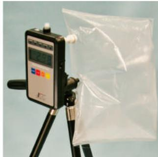
右写真のように、固定容器を用いずにガスバッグに直接保守できるポンプです。ダイヤフラムを使用していないので、ポンプに試料ガスを通しても、VOCの吸着はみられません。固定容器が不要で、音・振動もなく、サンプリング時のわずらわしさもありません。スマホと同じサイズで、小型です。作業環境測定にご利用ください。
