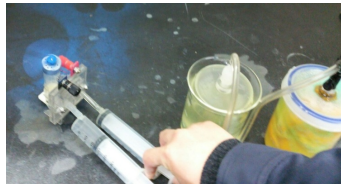
発酵で得られた水素を燃料電池に投入し発電しファンを回転させている写真
