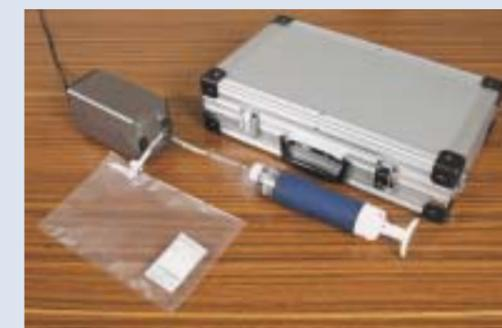
触媒酸化 検知管法による簡易VOC測定システム
